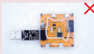
書き込み機を挿す向きを間違えている
